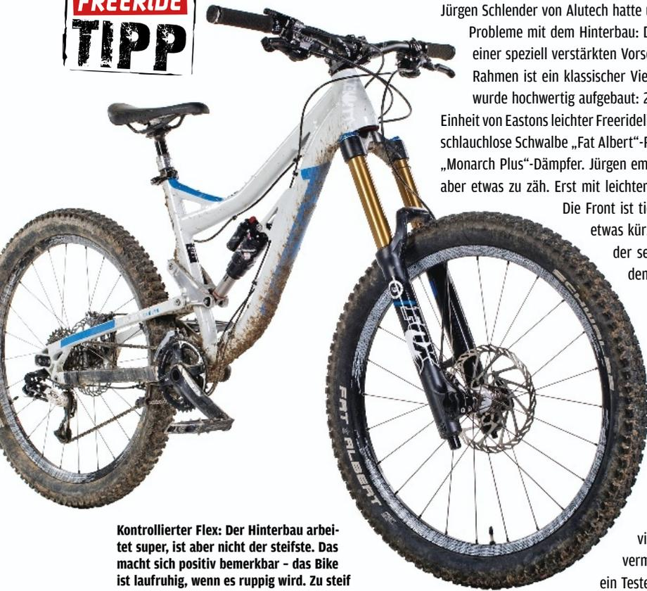
**Kontrollierter Flex:** Der Hinterbau arbeitet super, ist aber nicht der steifste. Das macht sich positiv bemerkbar – das Bike ist lauffruhig, wenn es ruppig wird. Zu steif wirkt schnell nervös. Die Front ist im Gegenzug wieder sehr massiv ausgelegt – eine gute Lenkpräzision ist das Ergebnis.
